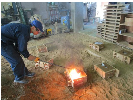
<画像 2 金属を流し込む鑄込み作業>
