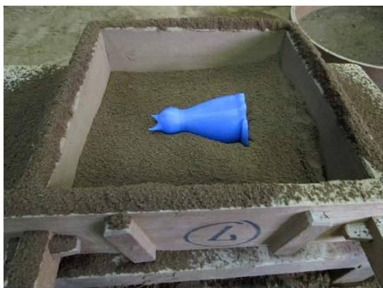
<画像 1 樹脂を埋め込んだ砂型の製作>
