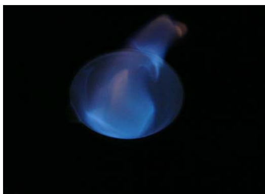
図4 (バイオマスエタノールの燃焼実験) (木屑～: 1mlで約2分の燃焼時間)
