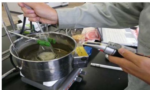
図2 (木屑セルロース糖化実験と糖濃度測定)
