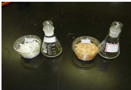
図3 (裁断紙(左)及び木屑(右)を原料にして合成したバイオマスエタノール)
