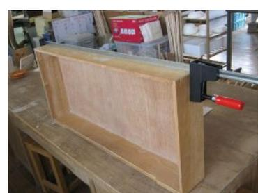
このクランプを使うことで横幅の広いものをしっかりと固定でき、正確に製作できるようになった。長いクランプではあるが軽量で生徒にも扱いやすい。また道具箱の補修の際にも大変重宝している。
