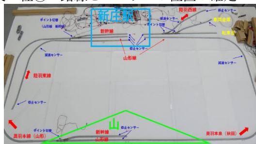
写真：レールとセンサー配置
